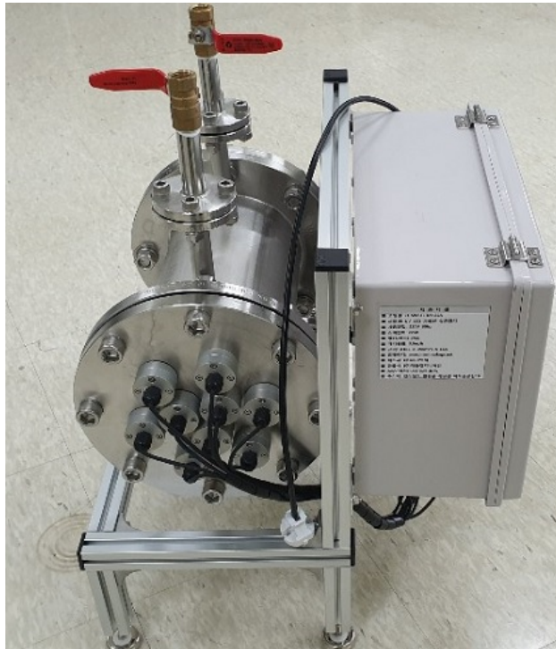
제이엔텍의 '음용수 자외선 살균기'는 자외선 엘이디(UV LED) 빛을 이용해 음용수를 빠른 시간 내에 살균한다.
