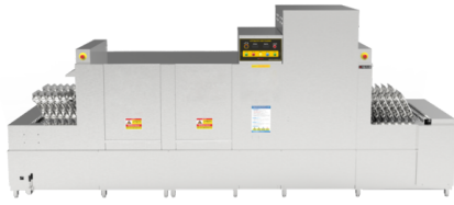
자숨의 혁신제품 '식판 각도 조절형 세척기'는 단체 급식 장소에서 사용하는 식기의 각도 등을 조절해 세척력을 높였다.
