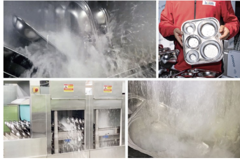
자숨의 혁신제품 '식판 각도 조절형 세척기'는 단체 급식 장소에서 사용하는 식기의 각도 등을 조절해 세척력을 높였다.
